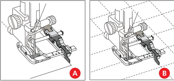
› 将布料放在压脚下，布边 (A) 或接缝 (B) 对着定规。(插图 3)
