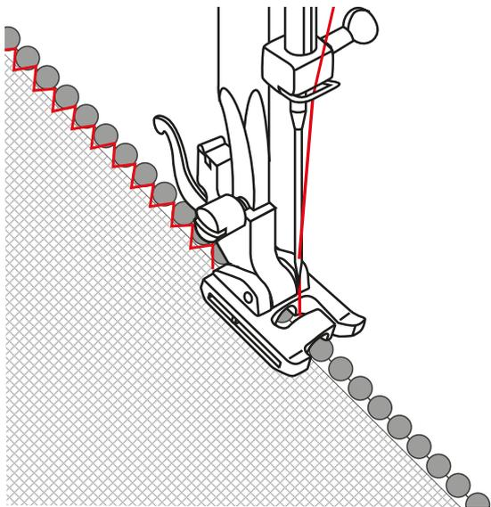
› 或把布料放在凹槽左侧，将珠串沿着布料右侧引导，将珠串车缝到布边。（插图 3）
