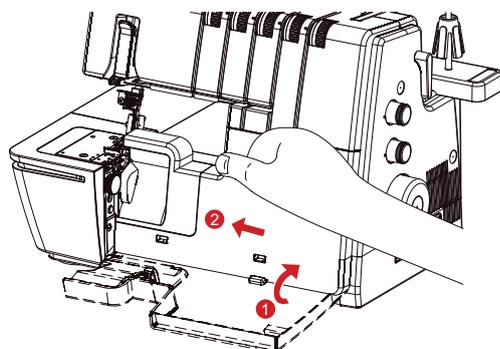
Если крышка нитевдевателя не закрывается полностью, значит, соединение пневмозаправки не включено.
