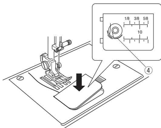
1 Вставьте шпульку в шпуледержатель. Проверьте, чтобы нить разматывалась против часовой стрелки.
