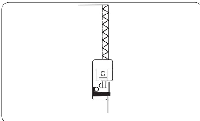
Эта строчка используется для одновременного стачивания и обметывания узких швов, которые не надо разутюживать.
