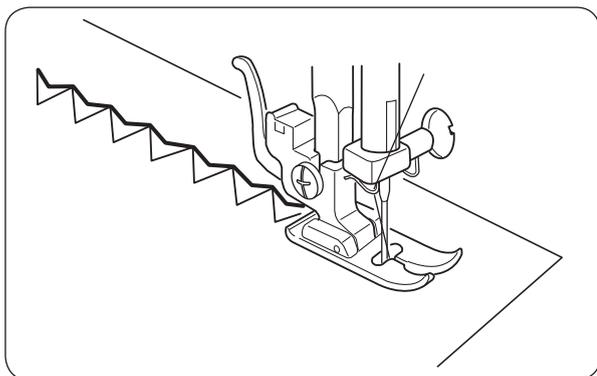
Quando il trasporto avanti e indietro, a causa del tipo di tessuto, non è uniforme, occorre regolare il bilanciamento. A tal fine, ruotare la manopola della lunghezza del punto nel modo seguente:
